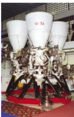
Оригинальностью отличалась схема бустерного агрегата "О", в котором привод осуществлялся окислительным газом после основной турбины с последующим перепуском его на вход в основной насос. На этой магистрали установлен впервые разработанный клапан "горячего газа", работающий в условиях кислородного генераторного газа с высокой температурой и при высоком давлении.
